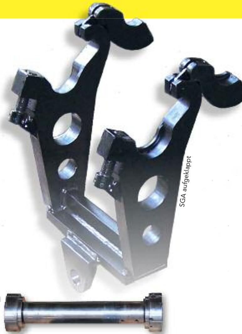
SGA Bolzen mit Klemmrings ersetzt den originalen Stielbolzen.
